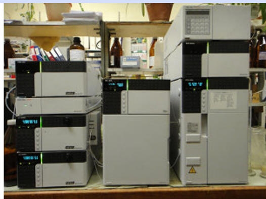
Хроматограф высокого давления LC-20 Prominence (Shimadzu, Япония)
