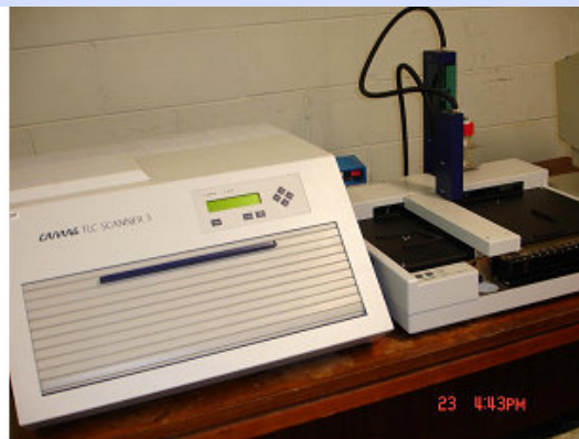
Полуавтоматический аппликатор Linomat V со сканирующим спектроденситометром TLC Scanner 3 (Camag, Muttenz, Швейцария)
